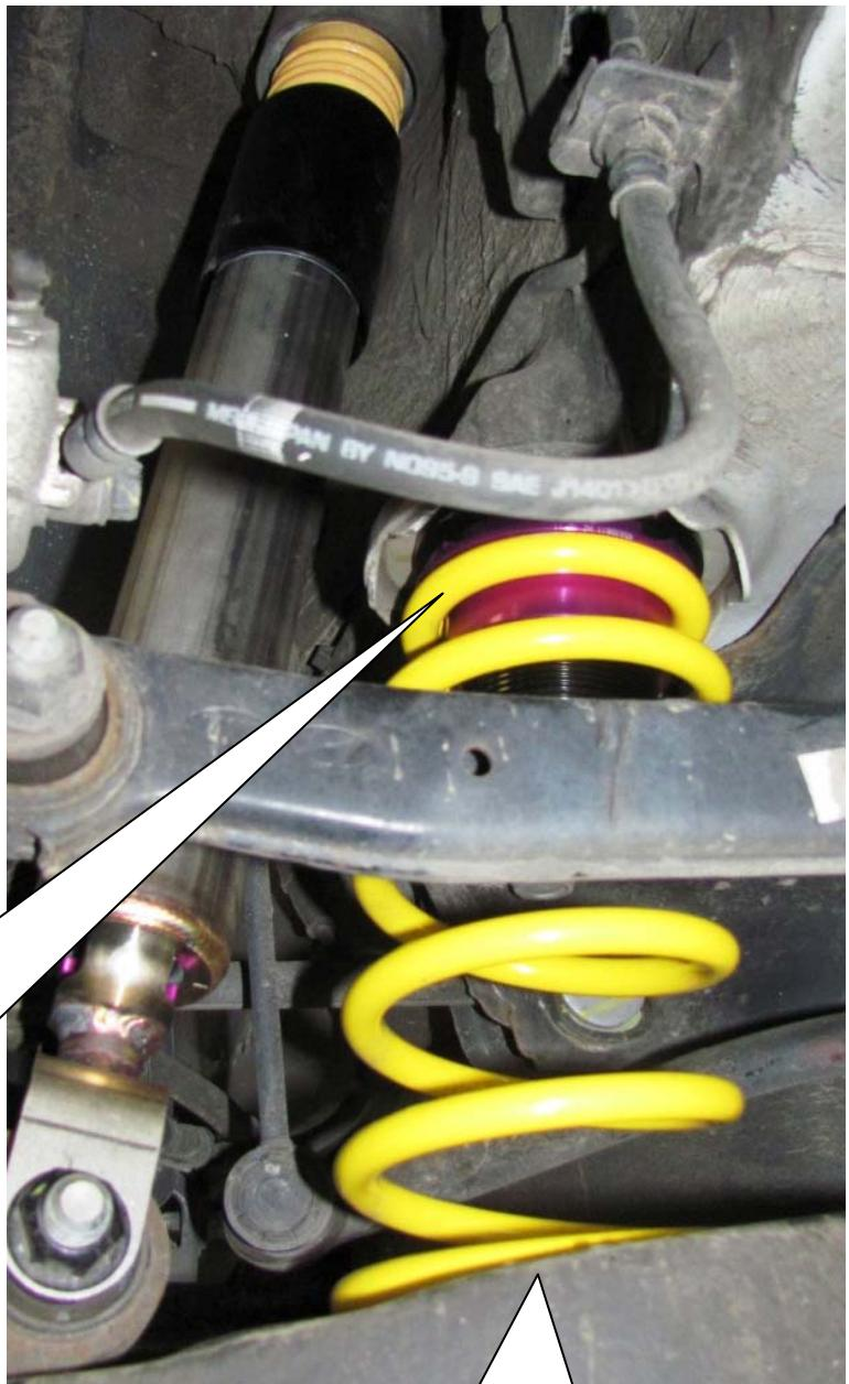
Am unteren Ende der Feder wird die Original Federunterlage weiterverwendet.
