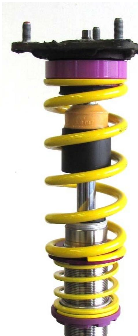
Nach erfolgtem Einbau des Fahrwerkes ist die Freigängigkeit der Bereifung zum VA-Federbein zu überprüfen. Das Mindestabstandsmaß darf an der engsten Stelle **5 mm** nicht unterschreiten und ist gegebenenfalls mittels handelsüblicher Distanzscheiben wieder herzustellen.
