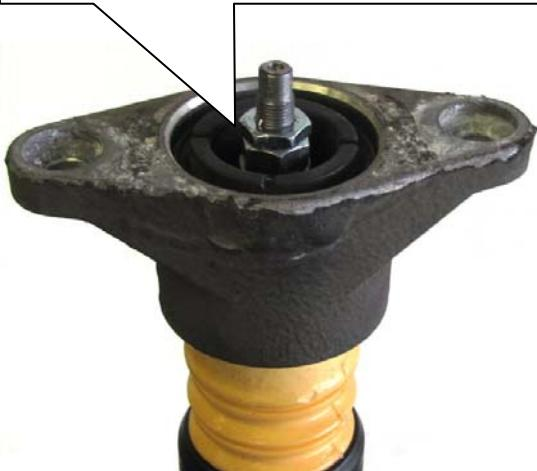
Die HA-Verstellung wird oben zwischen Feder und Karosserie montiert. Die serienmäßige Federunterlage entfällt. Zum Korrigieren (verdrehen des Gewinderings) der Fahrzeughöhe, ist die HA-Verstellung aus dem Fahrzeug zu demontieren.
