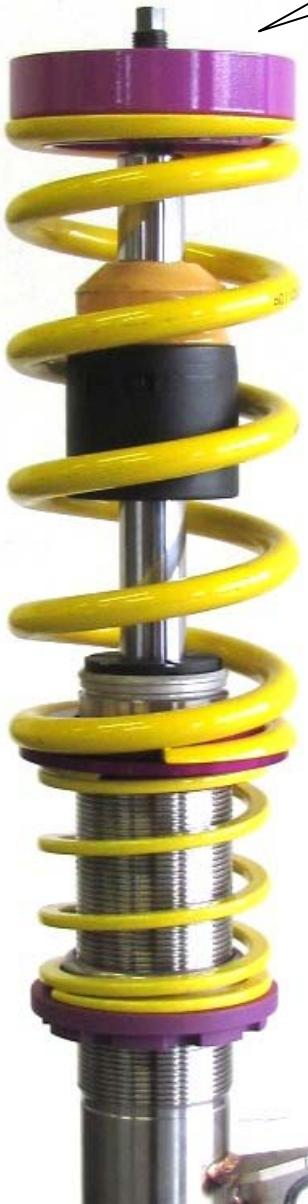
Die Kante an der Kolbenstangenaufnahme im Stützlager muss entfernt werden.
